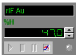
Die ersten drei Buttons sind nur im Online-Messbetrieb aktiv. Der vierte Button öffnet ein Y/t-Diagramm für diesen Kanal. Für die genaue Funktion der Einzelanzeigen im Online-Messbetrieb schlagen Sie bitte im entsprechenden Kapitel dieses Handbuchs nach.
