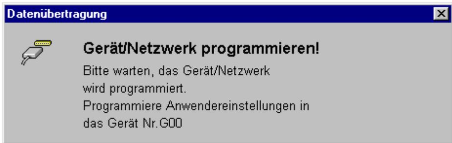
Hinweis: Nun können Sie das Messgerät von Ihrem Computer trennen und vor Ort aufbauen. Starten Sie den Messbetrieb am Messgerät, wenn Sie in der Zykluszeitsteuerung die Funktion „Starten durch Benutzer“ gewählt haben. Im anderen Fall führt das Messgerät die Messung mit den eingestellten Zeiten durch.
