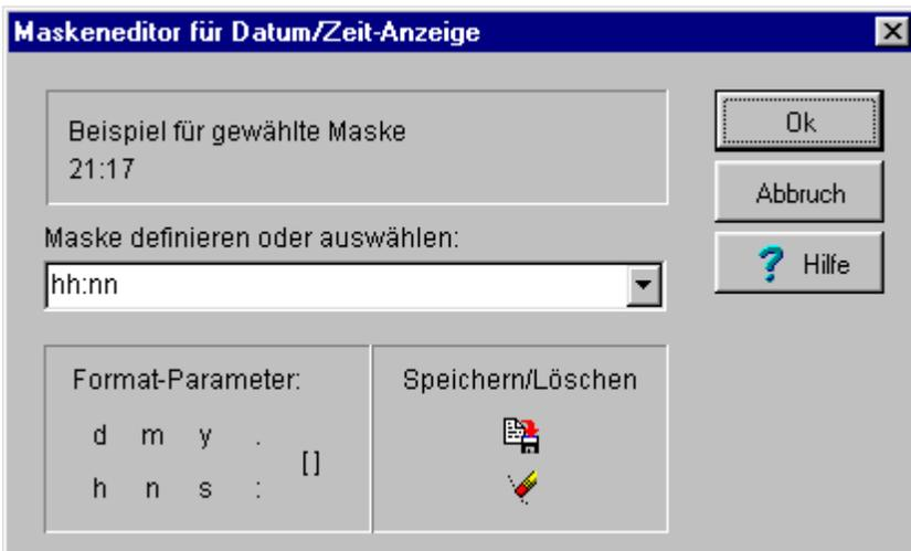
Wählen Sie das gewünschte **Zeitformat** für die X-Achse aus. Die ausgewählte Art der Zeitdarstellung wird beispielhaft angezeigt und erscheint im Diagramm. Mit den **Format-Parametern** können Sie sich individuelle Darstellungen generieren. Wählen Sie aus den Parametern per Mausklick mit der linken Maustaste. Das entsprechende Zeichen erscheint im Anzeigefeld.
