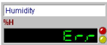
Die obere LED-Anzeige signalisiert einen **Fühlerbruch**. Sie leuchtet rot, wenn aktuell ein Fühlerbruch aufgetreten ist und gelb, wenn der Fühlerbruch in der Vergangenheit liegt.
