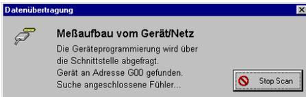
Das Programm findet nach dem Aufbau der Kommunikation automatisch alle ALMEMO-Messgeräte und Fühler trägt sie in die Geräte- und Kanaltabelle ein.
