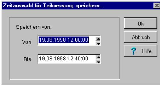
Geben Sie den gewünschten Zeitraum manuell ein oder halten mit der linken Maustaste Pfeiltasten gedrückt. Mit zunehmender Zeitdauer erhöht sich die Scrollgeschwindigkeit.
