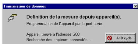
A l'établissement de la communication, le logiciel trouve automatiquement tous les appareils ALMEMO et les capteurs et les inscrit dans le tableau des appareils et des voies.
