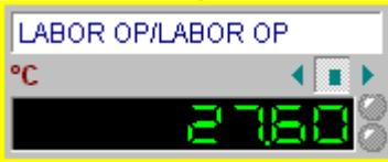
Überschreitet der Messwert den oberen Grenzwert ändert sich die Anzeige in rot, unterschreitet er den unteren Grenzwert, ist die Anzeige blau. Liegt keine Grenzwertverletzung vor, sind die Anzeigen grün dargestellt. Die obere LED-Anzeige signalisiert einen **Fühlerbruch**. Die untere LED-Anzeige signalisiert eine **Grenzwertverletzung**. Für die genaue Funktion der Einzelanzeigen im Online-Messbetrieb schlagen Sie bitte im entsprechenden Kapitel dieses Handbuchs nach.
