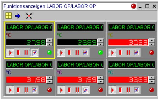
Die LED-Anzeige im Diagrammtitel leuchtet grün, wenn sich alle Kanäle im Messbetrieb befinden. Sie ist weiß, wenn die Datenaufzeichnung für einen beliebigen Kanal unterbrochen wurde (Stop-Taste). Sie blinkt gelb, wenn durch Drücken der Pause-Taste die Aktualisierung einer beliebigen Anzeige unterbrochen wurde. Sie blinkt rot, wenn eine aktuelle **Grenzwertverletzung** ohne Quittierung besteht.
