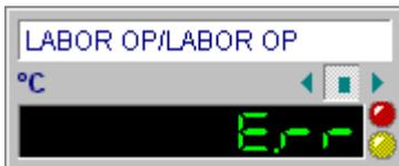
In der Einzelanzeige der Kanäle ist der **aktuelle Messwert** digital dargestellt. Überschreitet der Messwert den **oberen Grenzwert**, so ändert sich die Digitalanzeige in rot, unterschreitet er den **unteren Grenzwert**, ist die Anzeige blau. Liegt keine Grenzwertverletzung vor, sind die Anzeigen grün dargestellt. Liegt ein **allgemeiner Fehler** vor, z.B. keine Verbindung zum Fühler, wird dies in der Anzeige mit **E.rr** dargestellt.
