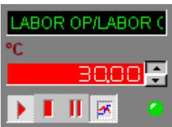
Die LED-Anzeige leuchtet im Messbetrieb grün. Sie ist weiß, wenn die Datenaufzeichnung für den Kanal unterbrochen wurde (Stop-Taste). Sie blinkt gelb, wenn durch Drücken der Pause-Taste die Aktualisierung der Anzeige unterbrochen wurde. Sie blinkt rot, wenn eine aktuelle **Grenzwertverletzung** ohne Quittierung besteht.
