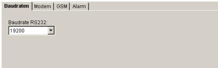
Auf der Registerkarte **Baudraten** stellen Sie die Übertragungsgeschwindigkeiten für die RS232-Schnittstelle in Abhängigkeit der in der Kommunikationsart ausgewählten Übertragungsstrecke ein.
