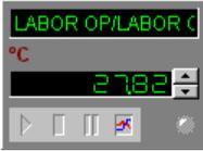
Die ersten drei Buttons sind nur im Online-Messbetrieb aktiv. Der vierte Button öffnet ein Y/t-Diagramm für diesen Kanal. Die LED-Anzeige signalisiert mehrere Informationen. Zur Anzeige der **Grenzwerte** halten Sie die Pfeiltasten gedrückt.
