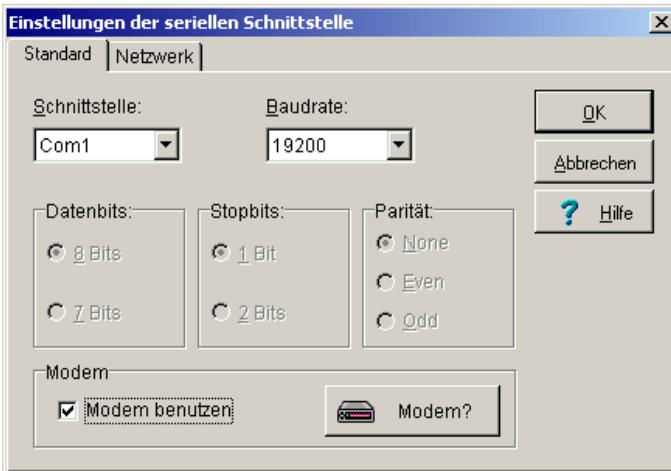
*Hinweis:* Die Datenübertragung mit einer **Baudrate von 19200 bit/s** ist für die Verwendung von **Standard-Modems** voreingestellt. Andere Übertragungsraten können zu Problemen bei der Datenübertragung führen und werden für Standard-Modems nicht empfohlen. Wenn Sie jedoch ein **GSM-Modem** benutzen wollen, müssen Sie hier derzeit eine **Baudrate von 9600 bit/s** einstellen.
